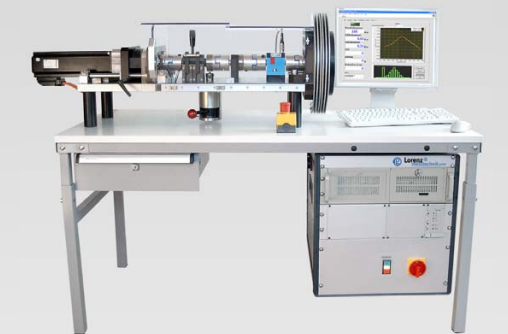
Drehmoment-Kalibriereinrichtung für Tretlager
